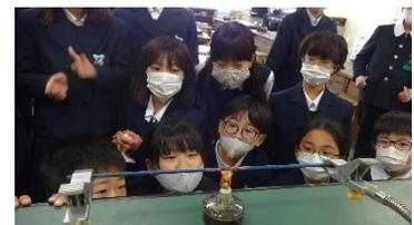
写真2 示温インクを使った演示実験
